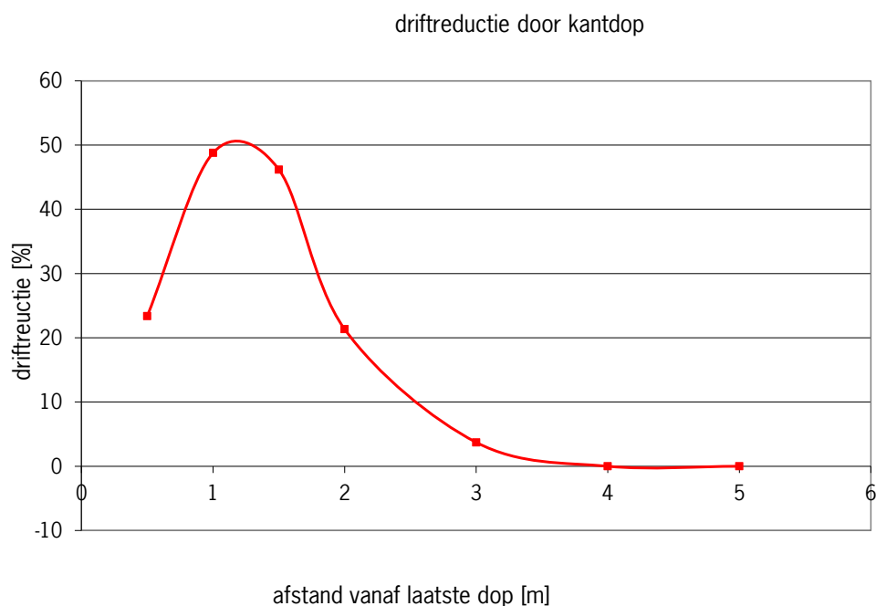
Figuur 2.1 Driftreductie (%) door gebruik van een TeeJet UB8504 kantdop bij gebruik van een TeeJet DG11004 spleetdop bij de bespuiting van een aardappelgewas.
